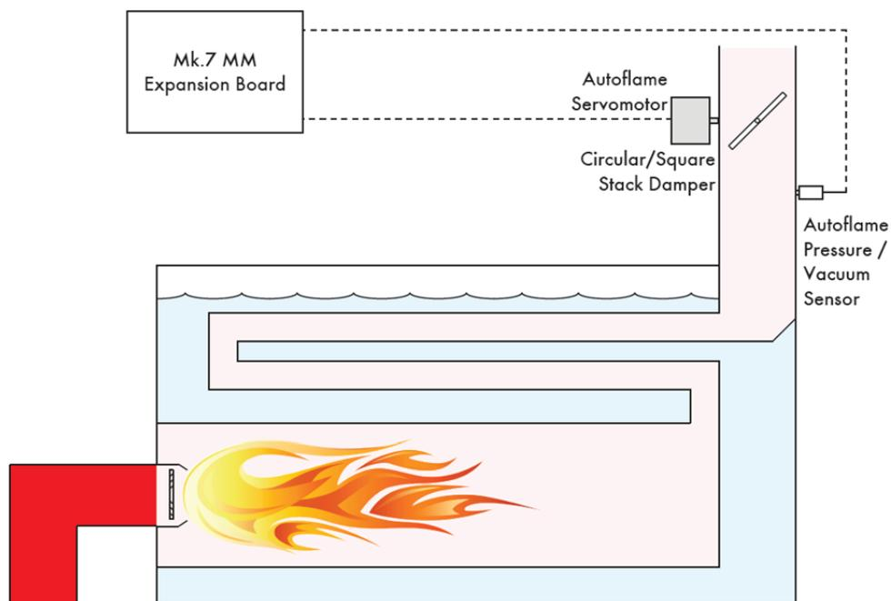
Figure 1.2.1.iii Draft Control Schematic
