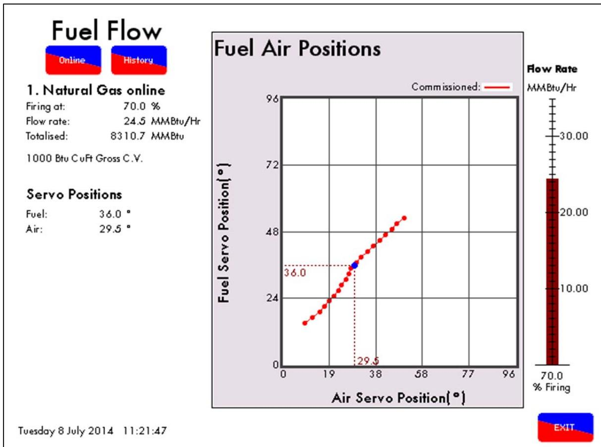
Figure 5.1.i Fuel Air Positions
