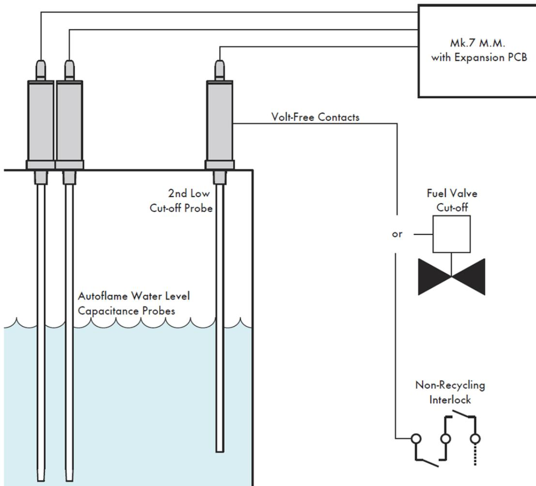
Figure 2.5.1.i 2<sup>nd</sup> Low Probe Diagram
